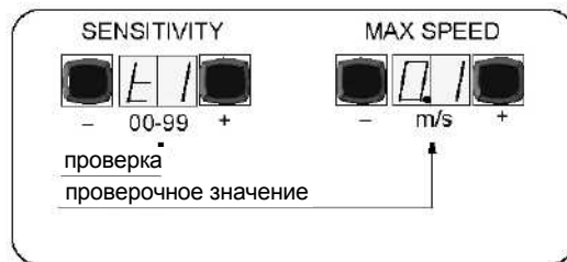
Рисунок 3 -6. Отображение проверочных значений на панели управления
